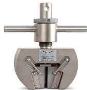
Fig. 8. Mordazas en cabezal (referencia)
