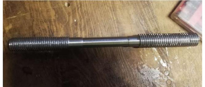
Fig. 10. Probeta de acero antes del ensayo
