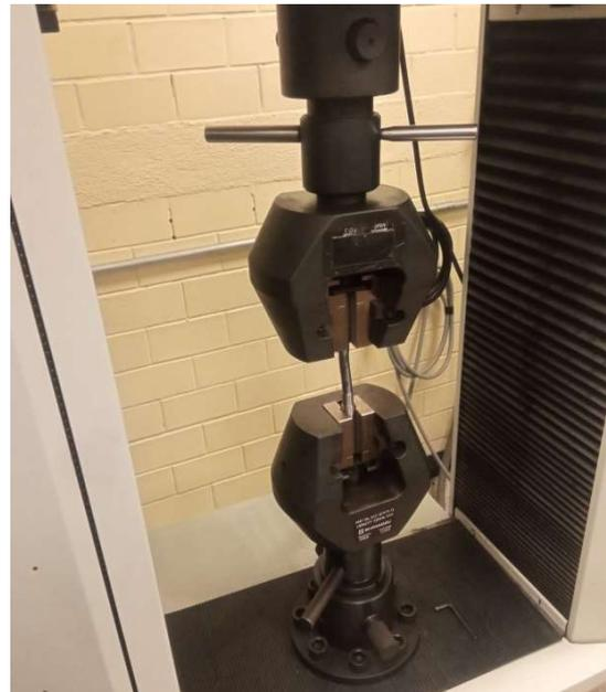
Fig. 12. Probeta ajustada antes de comenzar el ensayo
